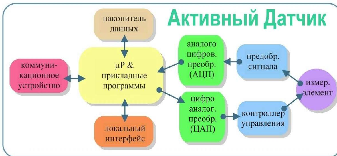
Рис.2 Принципиальная архитектура компонент активных датчиков.
