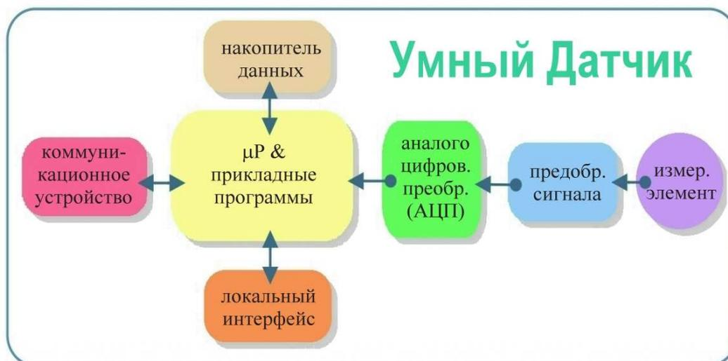
Рис.1 Принципиальная архитектура компонент интеллектуальных датчиков [2].
