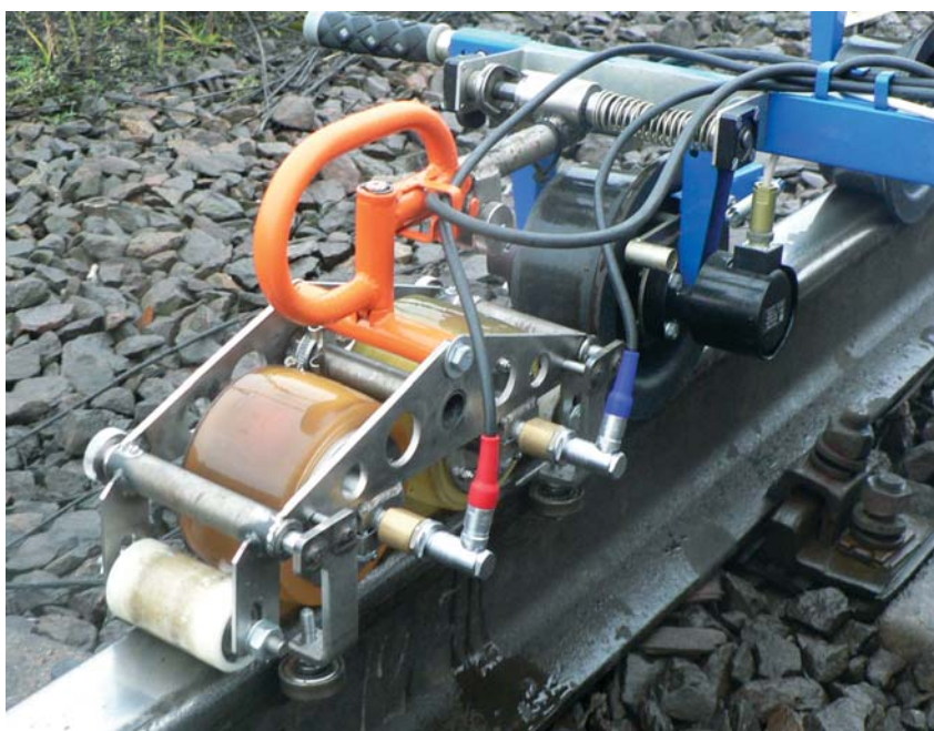
УЗ колесная система «АВИКОН-14»
