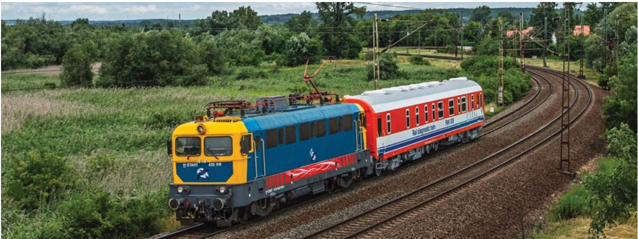
Венгерский вагон-дефектоскоп FMK-008 с аппаратурой «АВИКОН-03М»
